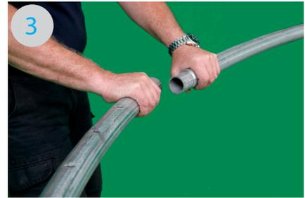
3 Bei der letzten Verbindung stehen Sie ausserhalb des Rahmens und ziehen die 2 Rohre nach Aussen, bis die beiden Rohre ineinander gesteckt werden können.
