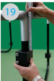
Der Flexiklotz 6 cm unterhalb der Fussstützen parallel zum Rahmen festziehen.
